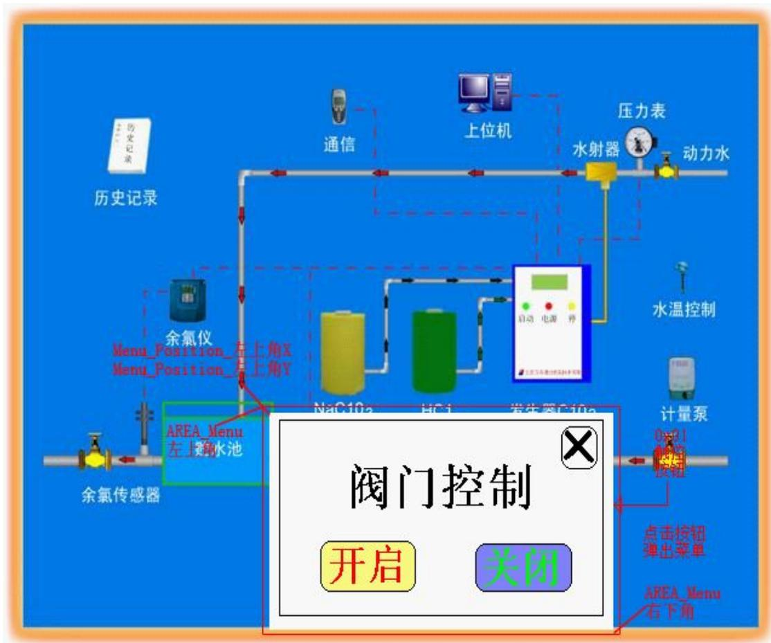
上图中：弹出的菜单在另外的界面上，“开启”和“关闭”两个按钮配置的键码（0x0000-0x00FE）将被返回给 0x01 触控按钮所指向的变量；取消按钮设置键码为 0x00FF，点击时不会返回值。
